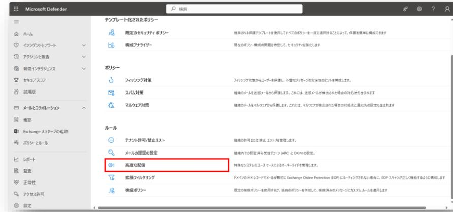
③高度な配信画面の「フィッシングのシミュレーション」を選択し「編集」をクリックして下さい。
